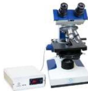
**Imagen 10.** Microscopio de contraste con calefacción.
