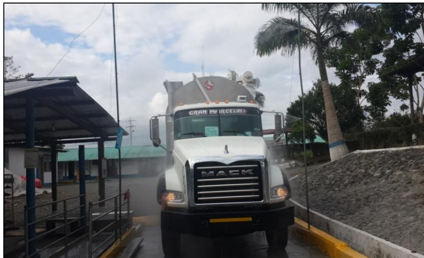
Figura 37 Arco y Vado sanitario Fuente: PRONACA
