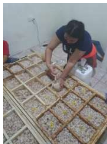
Aplicación de enzimas y levaduras a la masa fermentativa
