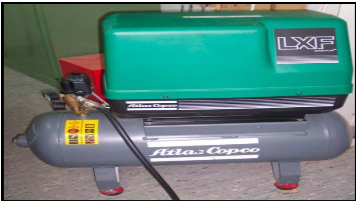
Figura. 5. Compresor con su depósito
