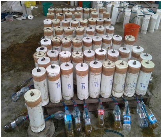
Imagen 3. Microsilos llenados con las muestras
