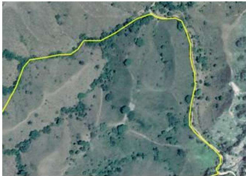
*Figura 7. Ejemplo de delimitación de predios generados a través del registro de coordenadas a nivel de campo, luego ajustado con el uso de Ortofotos a escala 1:5.000*
