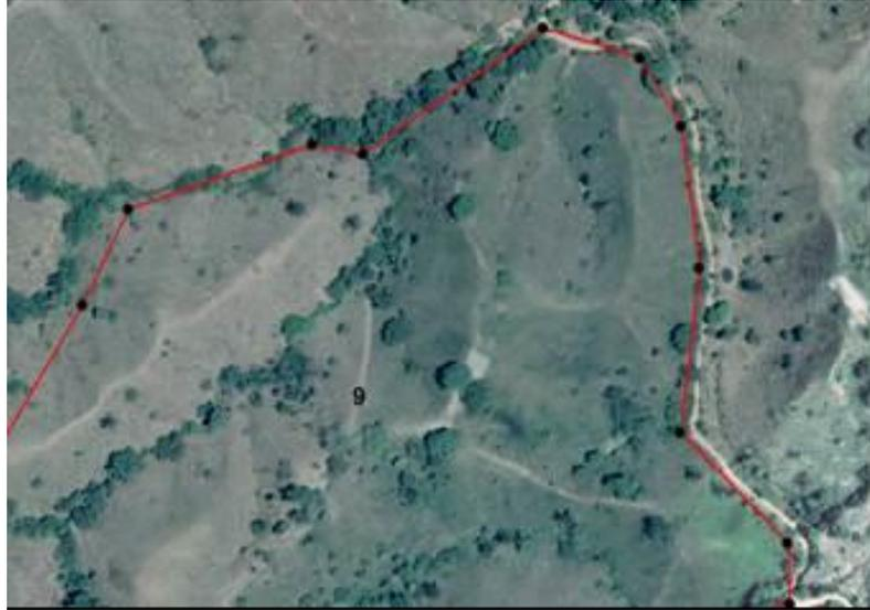
*Figura 6. Ejemplo de delimitación de predios generados a través del registro de coordenadas a nivel de campo.*
