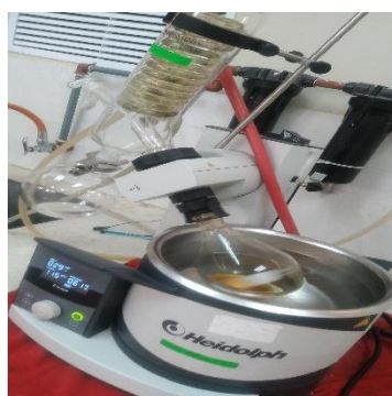
Destilación por rotavapor (115 rpm, 61 °C, 45 minutos)
