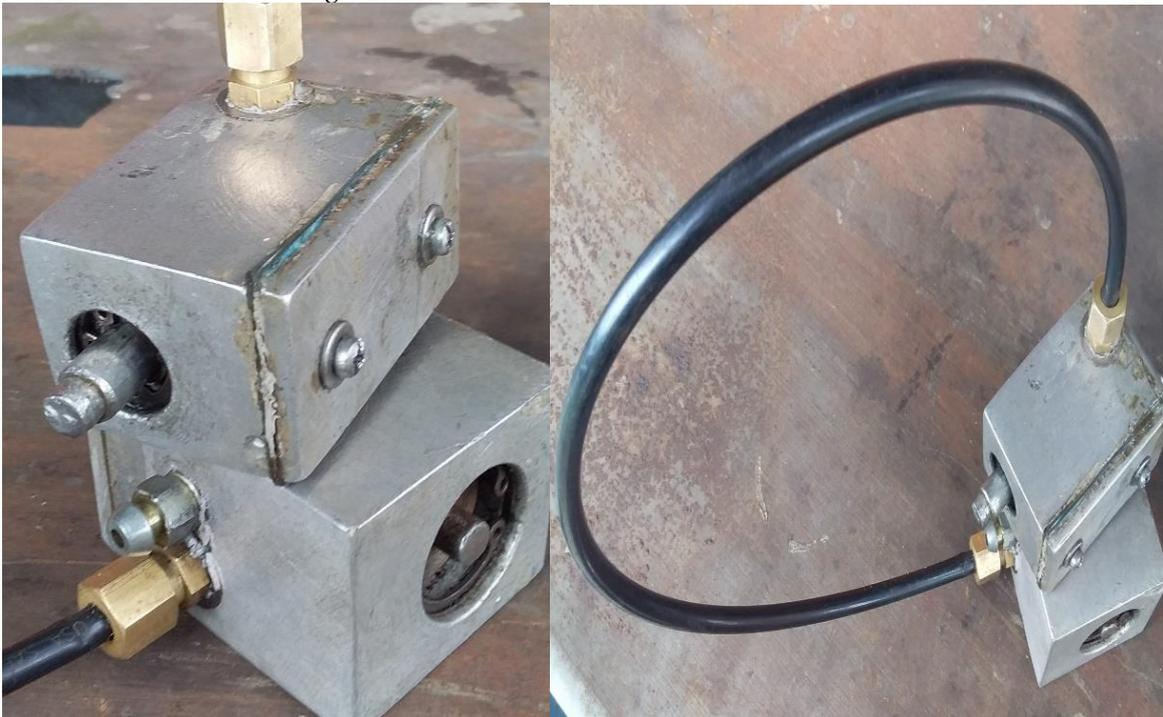
Anexo 18 *Palanca y base del muelle de la guía deslizante*
