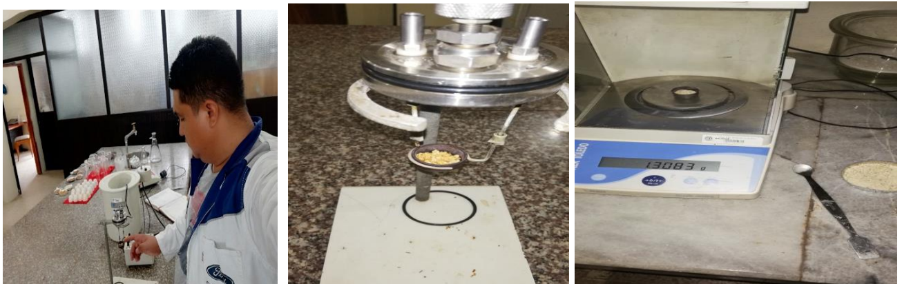
Obtención del contenido de energía de las distintas muestras
