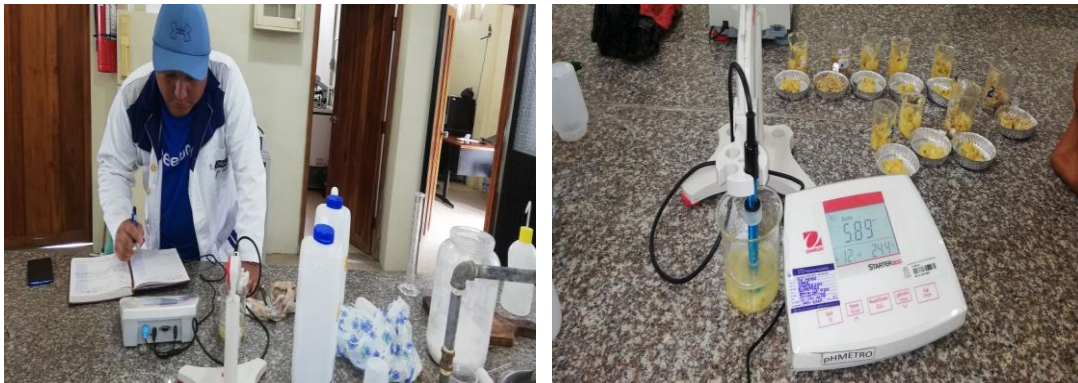
Determinación del nivel de pH de las muestras
