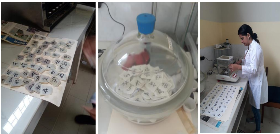
Anexo 18: Retiro de las muestras de la estufa, medidas en el desecador y pesadas.
