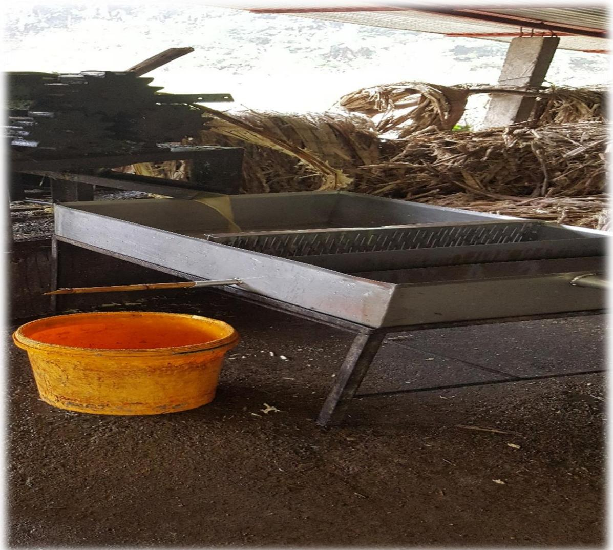
**Figura 25.** Filtración y decantación del jugo
