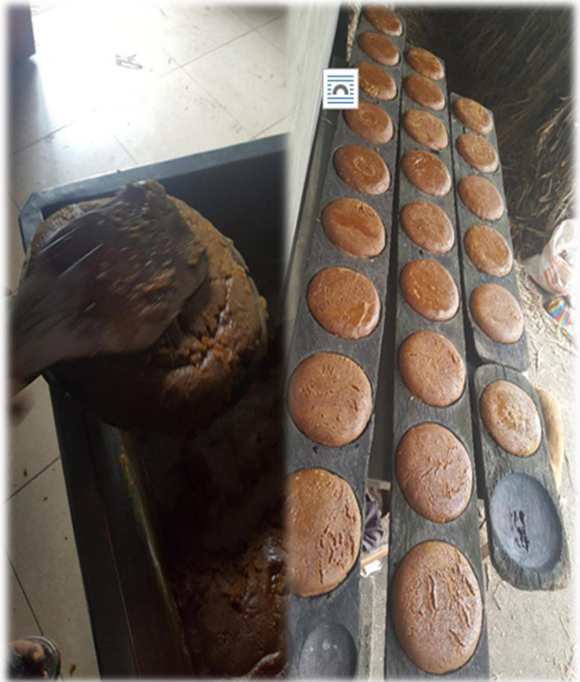
**Figura 30.** Obtención de la panela en barra “Moldeo y Empaque”
