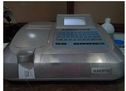
**Imagen 15.** Espectrofotómetro utilizado en el laboratorio.
