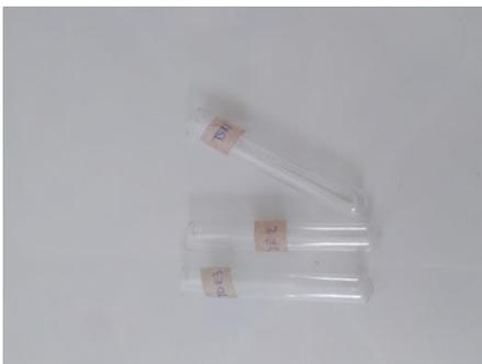
**Imagen 13.** Tubos de ensayos al vacío rotulados para la inserción de la muestra.
