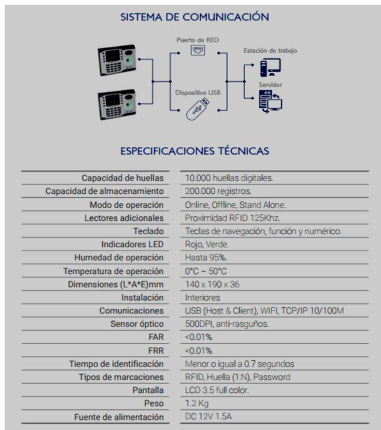
**Figura 34:** Características de Reloj Biométrico
