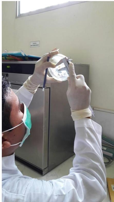
**Anexo 18.** *Medición del crecimiento radial del hongo con la utilización de un calibrador cada 24 horas después de la siembra del hongo.*
