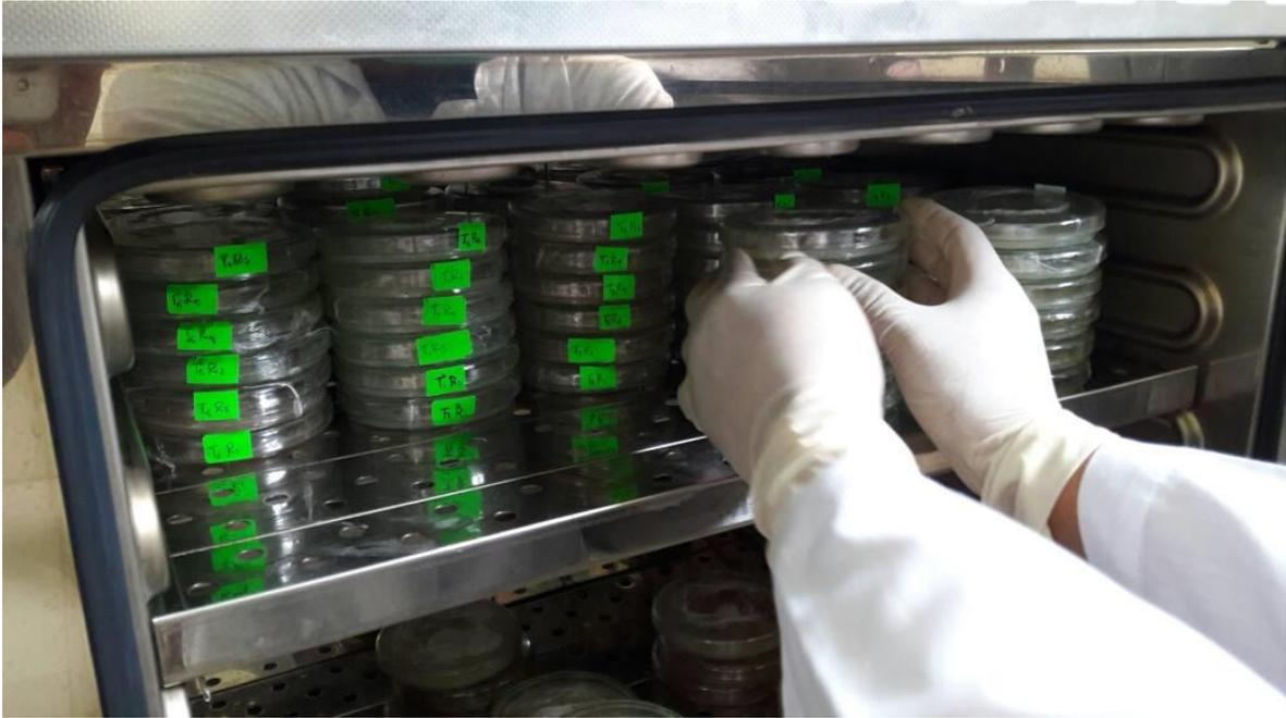
**Anexo 17.** *Incubación de las cajas rotuladas con sus debidos tratamientos y repeticiones en una estufa a 30,5 °C.*
