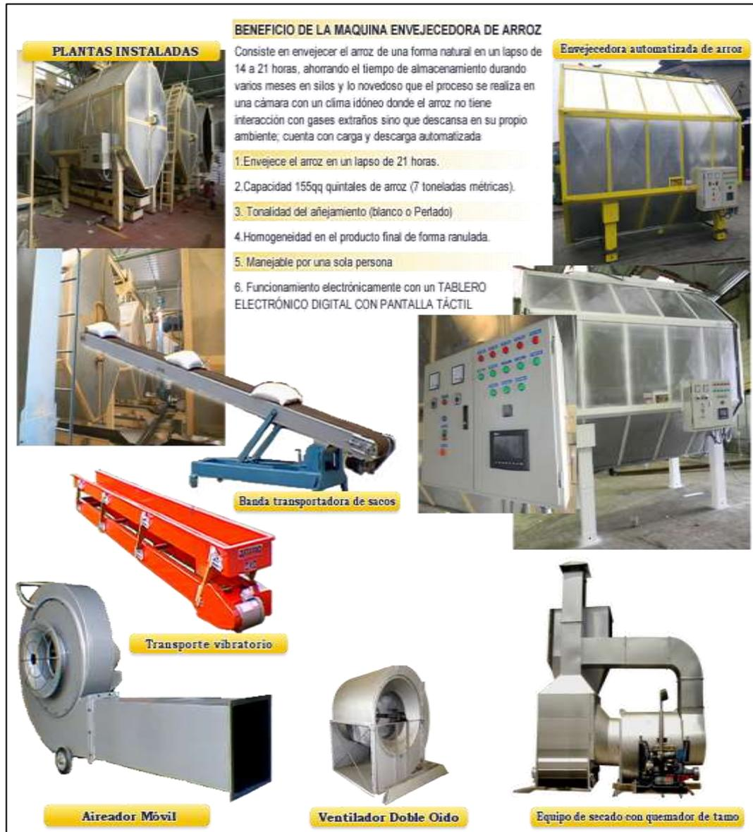
Figura 10. Máquina envejecedora de arroz.
