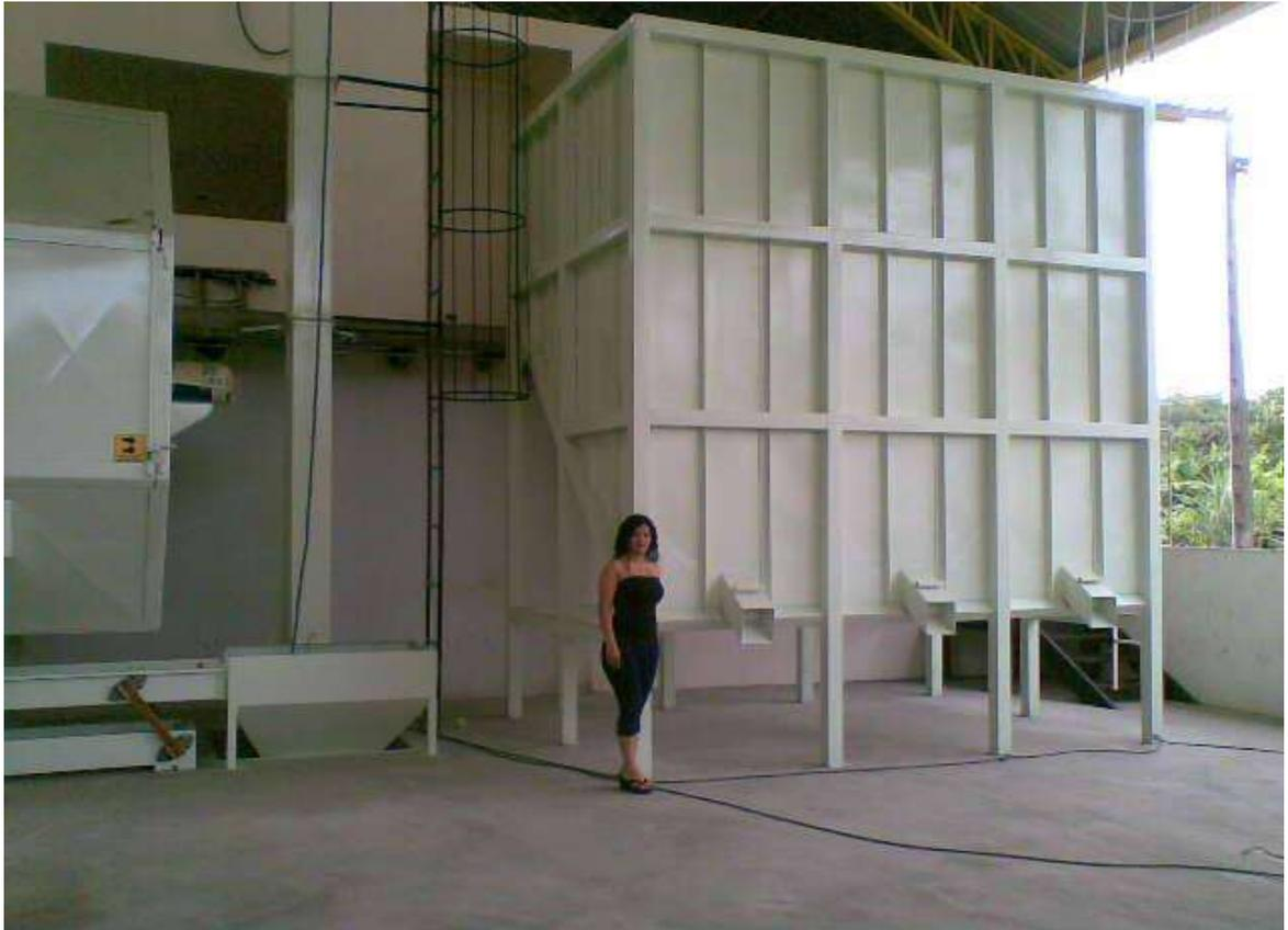
**Figura 8.** Tolva de Almacenamiento de arroz pilado.
