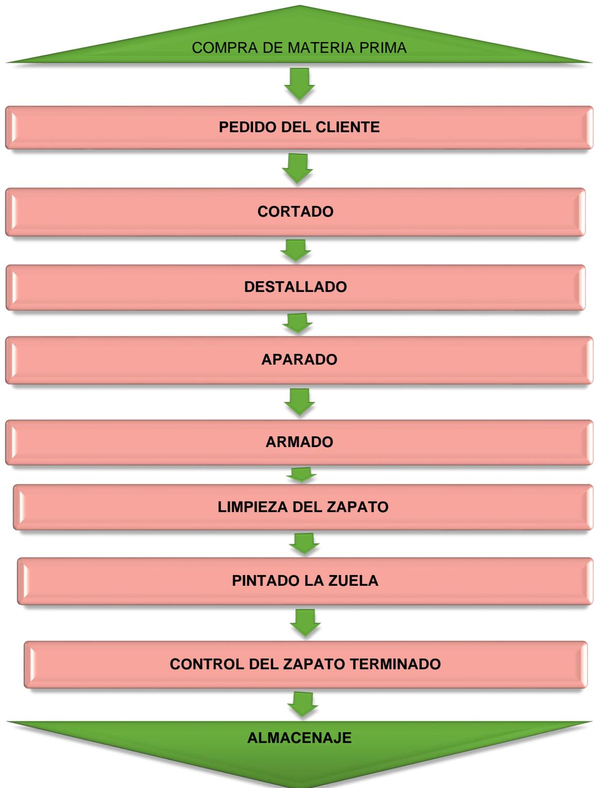
**Figura 1. Flujo de proceso de Producción**
