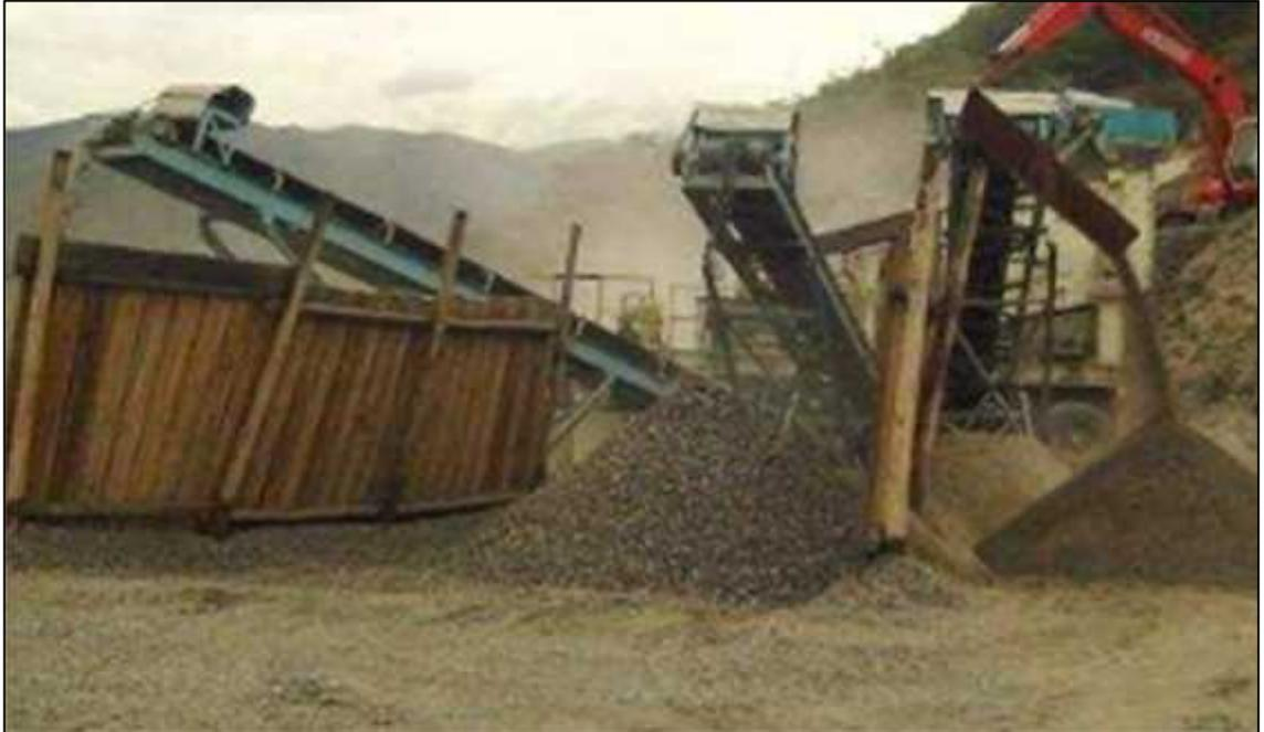
**Figura 3.** Trituración del Material Pétreo
