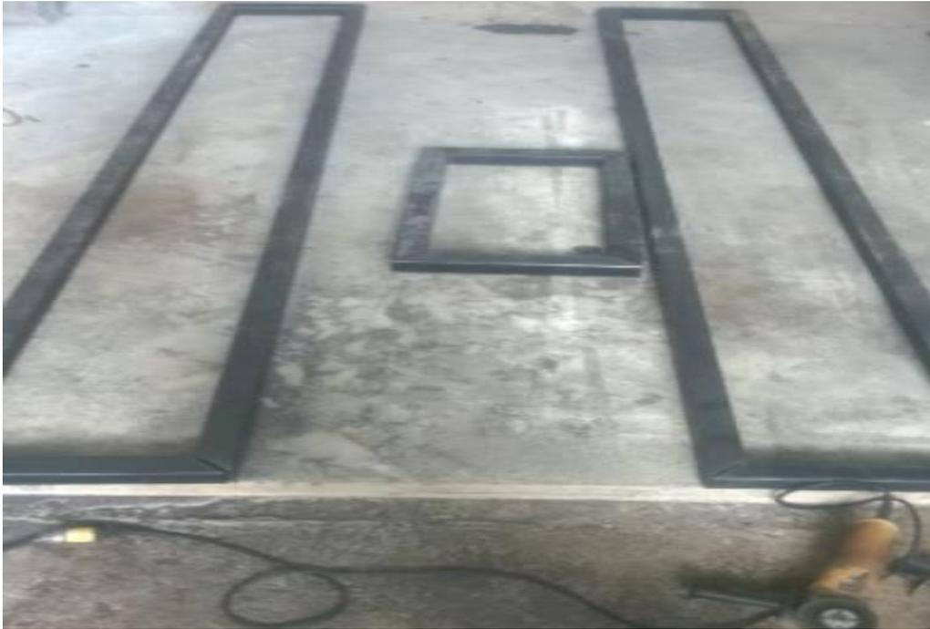
**Figura 28.** Electrodo 6011 fueron los utilizados para las uniones soldadas.
