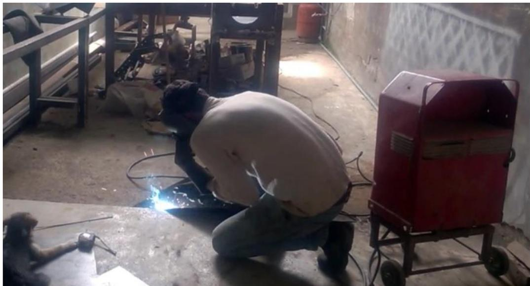
**Figura 33.** Soldadura de soportes para abrazaderas y rodillos.
