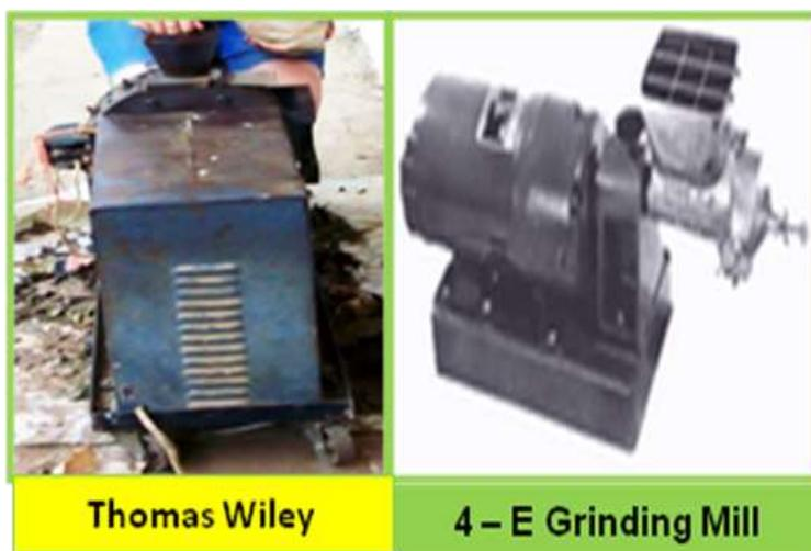
**Foto 4. Molinos eléctricos utilizados en la extracción de muestras.**
