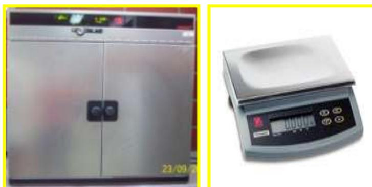
**Foto 3. Estufa y balanza para la determinación del contenido de humedad**
