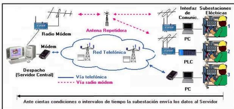
**Figura: 2 Sistemas de Telemetría con equipos de medición activos (Por Radio y por vía telefónica)**
