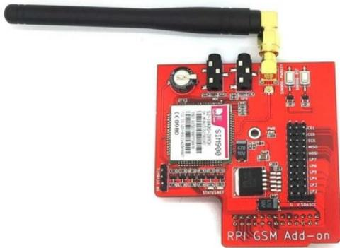
Figura: 6 SIM900 GSM/GPRS Add On V1.0
