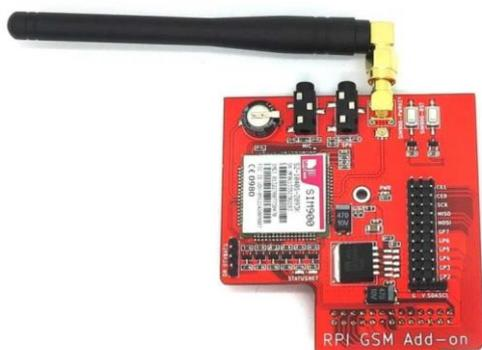
**Figura: 18 SIM900 GSM/GPRS Add On V1.0**
