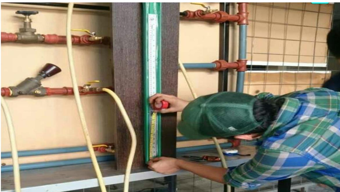
Fotografía N° 16. Diferencias de alturas entre dos puntos
