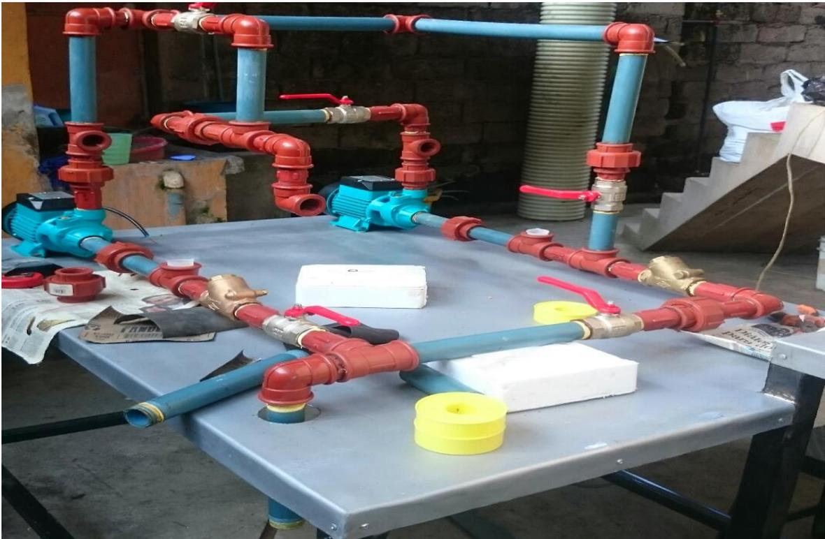
Fotografía N° 7 Conjunto medidor de caudal, codos 90°, uniones roscables, Neplos, Bushing de ¾ a 1”
