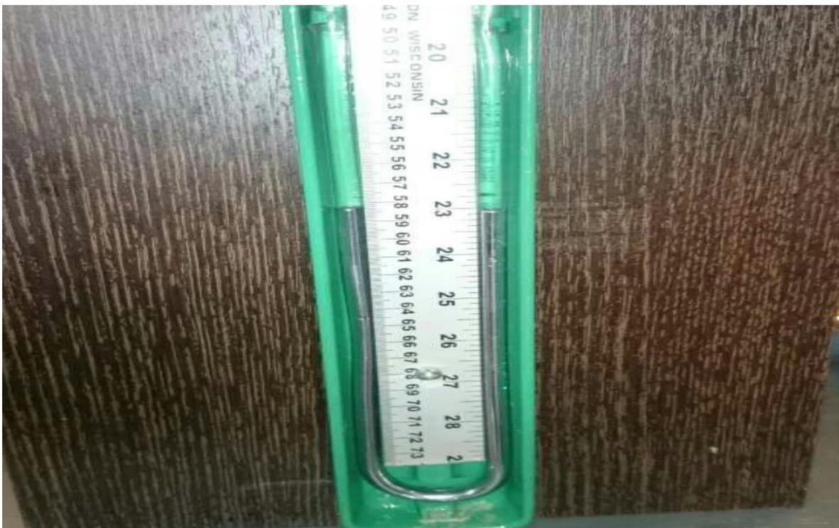
Fotografía N° 15. Medición de la diferencias de alturas.
