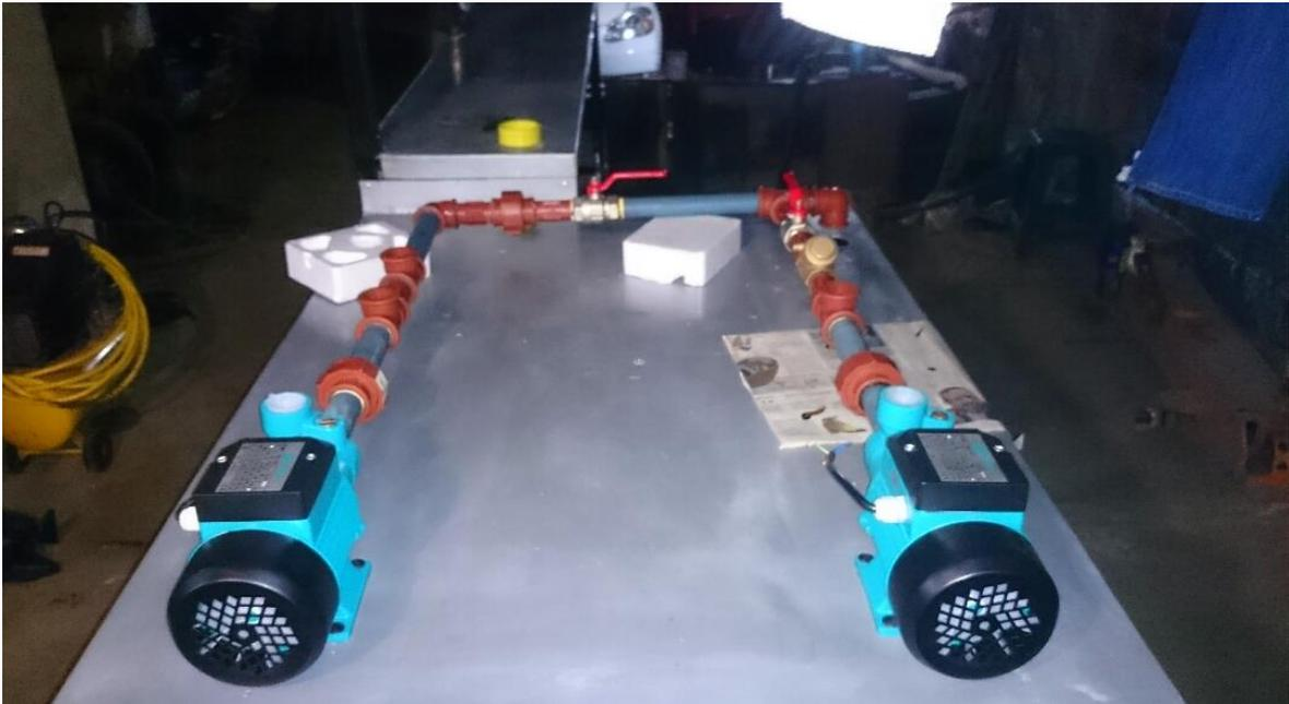
Fotografía N° 6. Conjunto armado de tuberías, te, Bushing, codo 90° unión universal, válvula Check, válvula de esfera, bombas.
