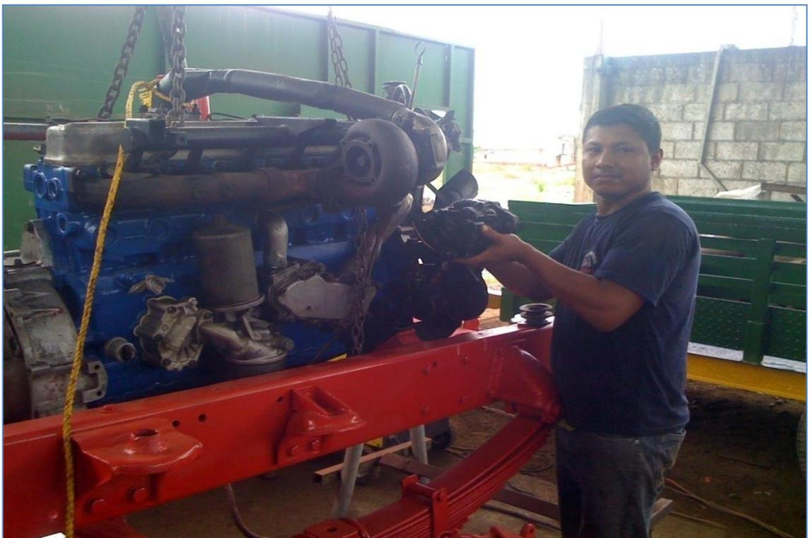
**Mecánico – instalación motor de camión (Sr. Iván Muñoz)**
