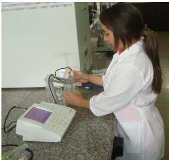
Colocación del electrodo en la muestra
