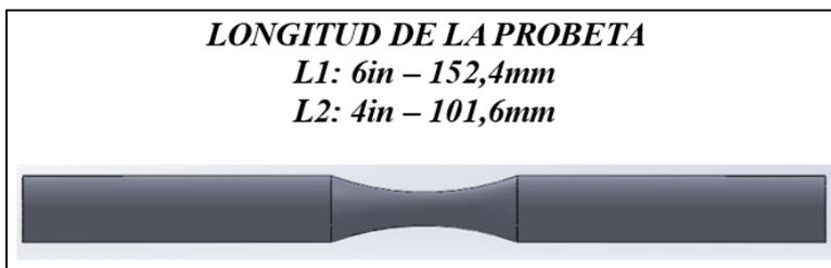
**Figura 4.47.** Dimensión de la probeta para ensayo de fatiga.
