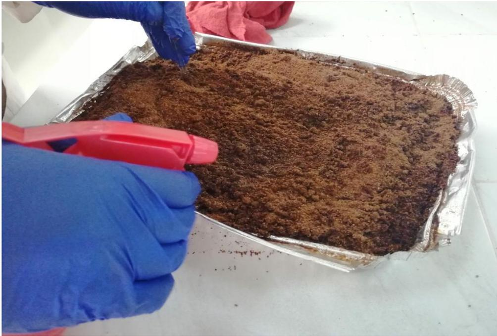
**Anexo 5.** Adición de ácido ortofosfórico para activación química del carbón activado.
