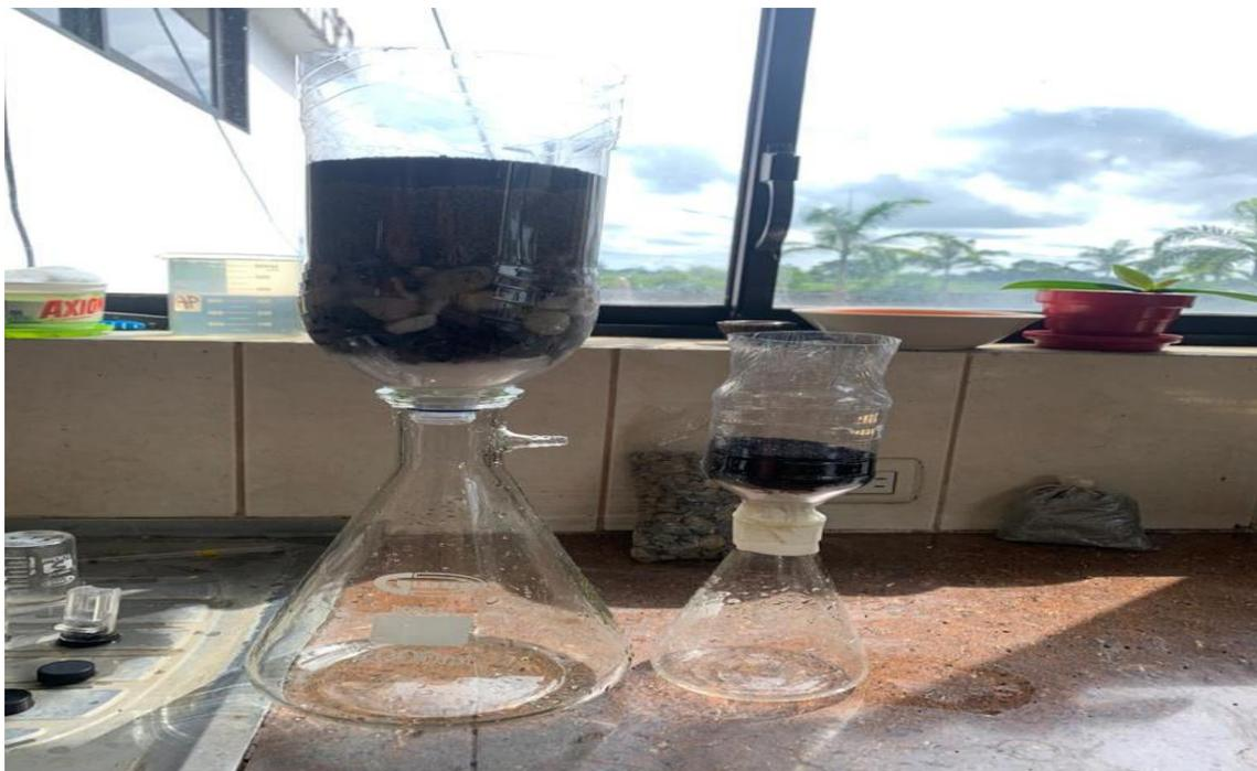
**Anexo 12.** Filtros de agua para prueba de absorción de las muestras de agua con carbón activado.
