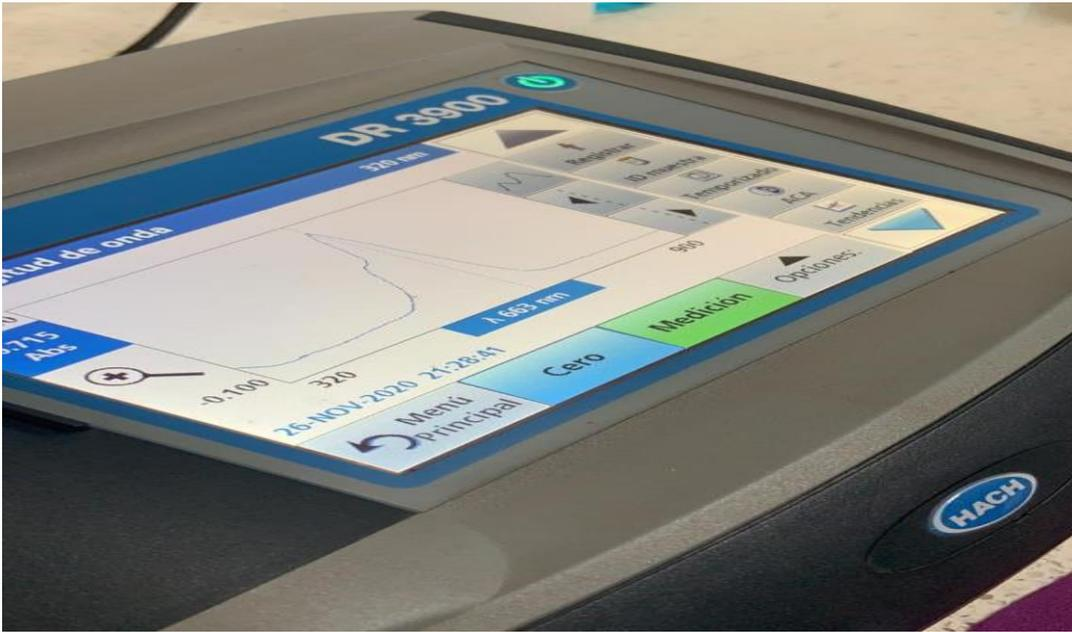
**Anexo 9.** Prueba de adsorción con azul de metileno en el espectrofotómetro.
