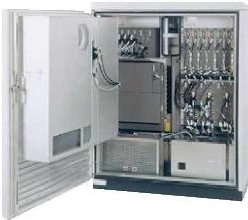
La RBS 2102 es una RBS para exterior que soporta hasta seis transmisores-receptores por gabinete. Se puede utilizar en configuraciones de 1, 2 y 3 sectores.
