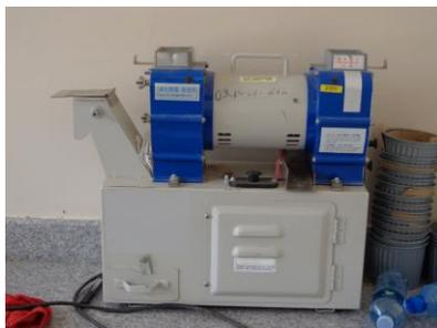
Muestras de cien gramos de arroz en cáscara fueron preparadas, en triplicado para cada tratamiento, siendo éstas colocadas en la compuerta de entrada del molino. Con el descascarador totalmente abierto, el equipo fue puesto en funcionamiento y, simultáneamente, abierto gradualmente el embudo, para permitir la operación de pilado en aproximadamente treinta segundos y noventa segundos para el pulido, siguiendo las instrucciones del fabricante.
