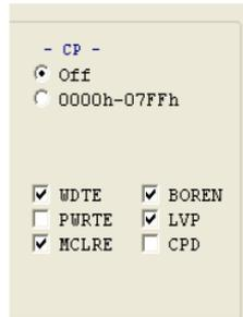
Figura 10. Bits de configuración del Microcontrolador Pic 16F628A.
