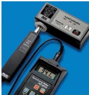
Figura 3. Sonómetro: control de calibración
