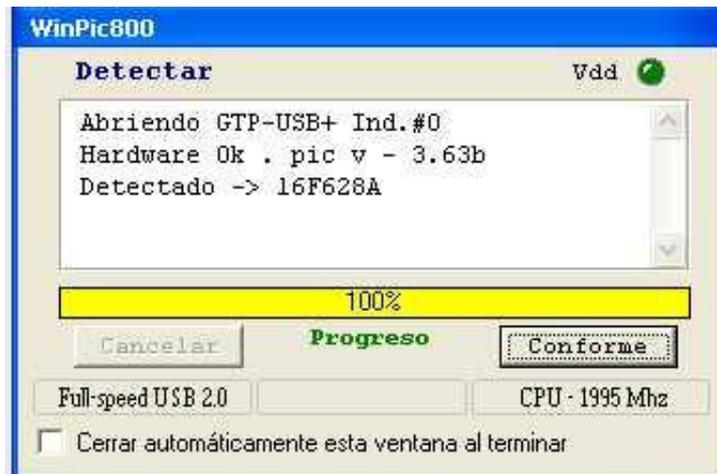
Figura 17. Ventana del proceso Verificando la programación del PIC 16F628A.
