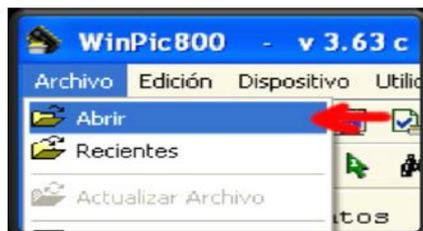
Figura 11. Botón Abrir para cargar programa a grabar en Microcontrolador Pic 16F628A.
